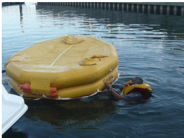
4 ひっくり返しに展開した時の戻し方 ラフトの底には水で安定させるドローグ付き
