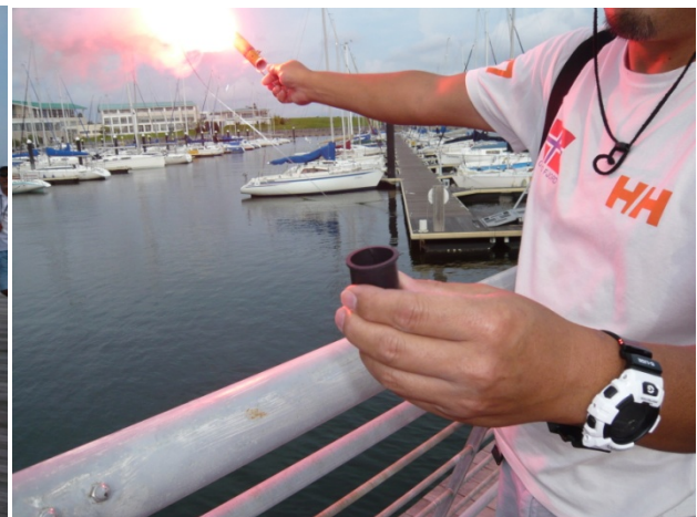
キャップを引くとキャップについたワイヤーで内部から点火するタイプ
