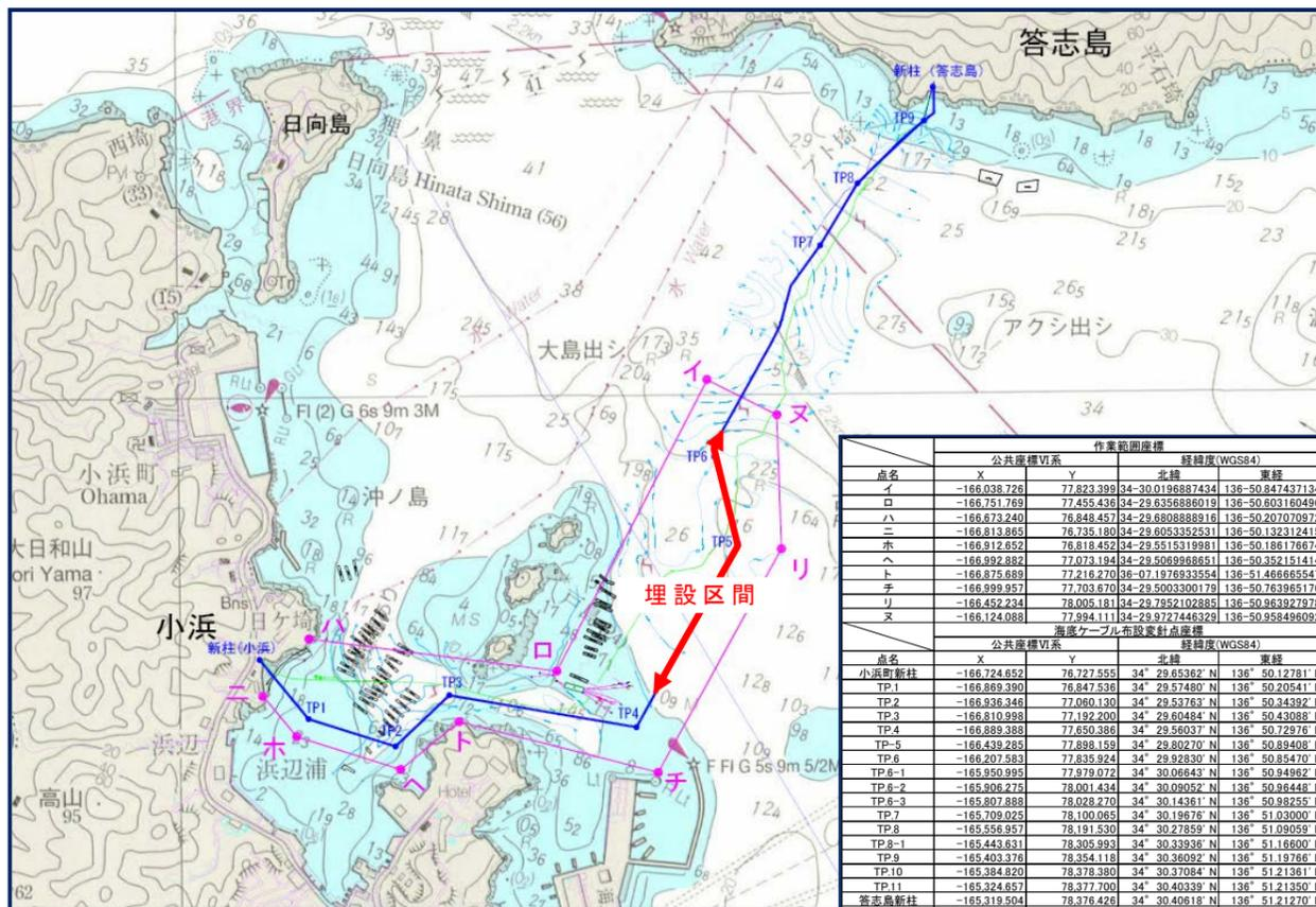
上記「埋設区間」において、日々の埋設工事が完了次第、完了地点海底に埋設機(右図参照)を残置します。
