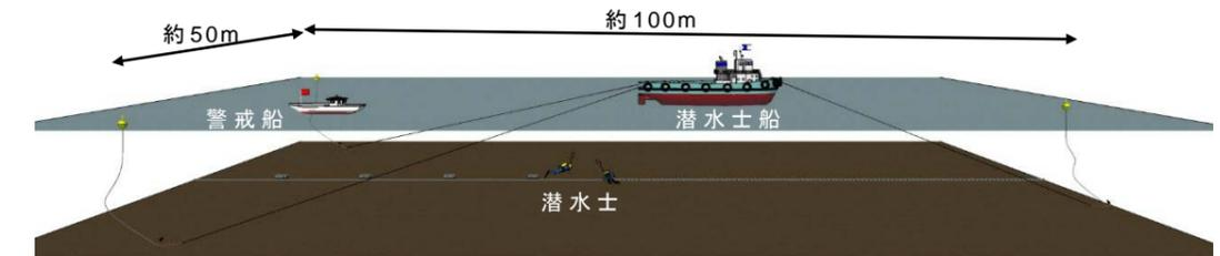
既設電力ケーブルに沿って潜水士を潜行させて、筏のアンカー及びロープ等と既設ケーブルの位置関係を確認して、撤去工事工法の検討資料とします。
