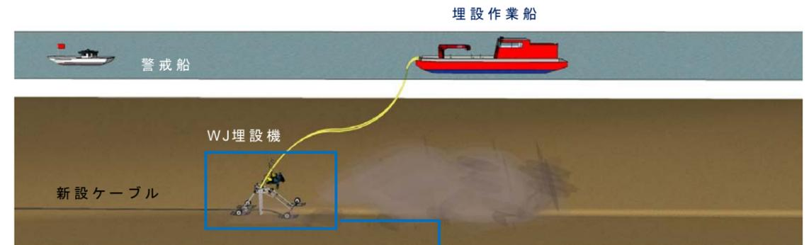
埋設作業船上のポンプから海水を埋設機に圧送して、高圧のウォータージェットを海底に噴射する事で海底面に布設されたケーブルを海底下に埋設します。
